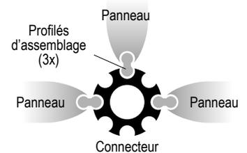
Un assemblage de panneaux en angle, en « X » ou en « T » nécessitent un connecteur. Celui-ci est relié aux panneaux grâce aux profilés d'assemblage inclus avec le panneau.
