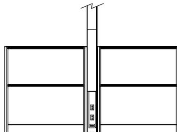
Les colonnettes de 6" s'installent de la même façon que les panneaux Nano avec le profilé d'assemblage fournis.
