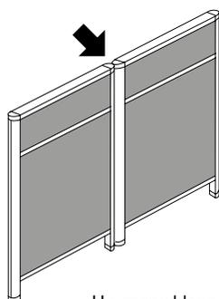
Un assemblage de deux panneaux en ligne (180°) ne nécessite pas de connecteur. Ceux-ci sont reliés grâce au profilé d'assemblage inclus avec le panneau.
