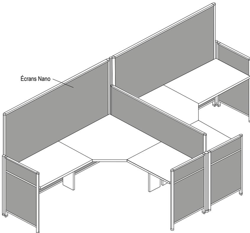
Lorsqu'un assemblage de deux panneaux de hauteurs différentes est spécifié, le connecteur utilisé peut être de la même hauteur que le panneau le plus petit.
