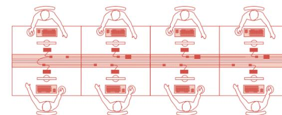
Système électrique quatre circuits
