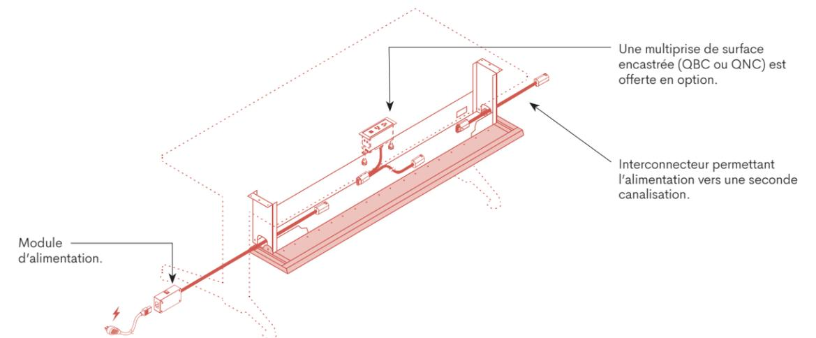
Système électrique un circuit
