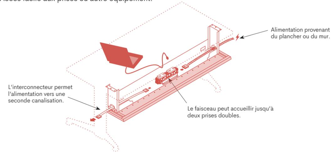
Système électrique un circuit
