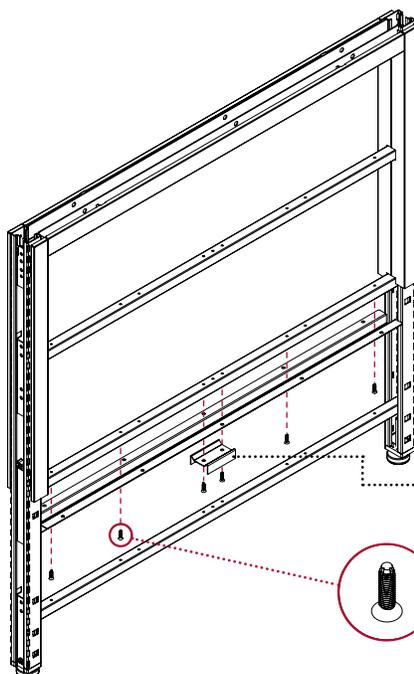
Installer la butée de tuile en métal vis-à-vis la découpe prévue à cet effet avec les vis auto-perçantes si les trous sont utilisés pour un faisceau électrique. /
